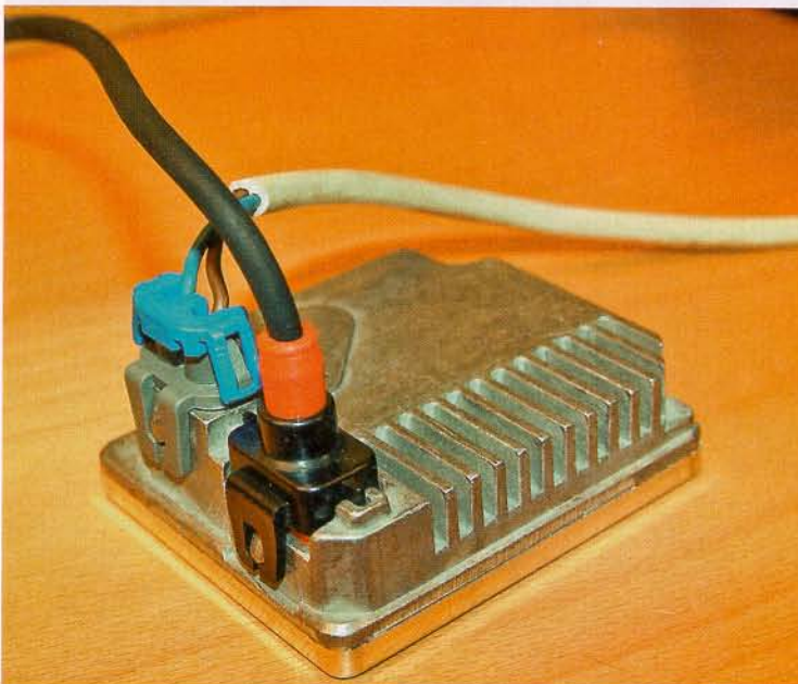
Kaikki xenon-valaisimet tarvitsevat erillisen sytytysyksikön. Se voi olla integroitu valaisimen sisälle tai sitten erillinen elementti. Kuvassa näkyvä musta johto on korkeajännitejohto polttimolle.
