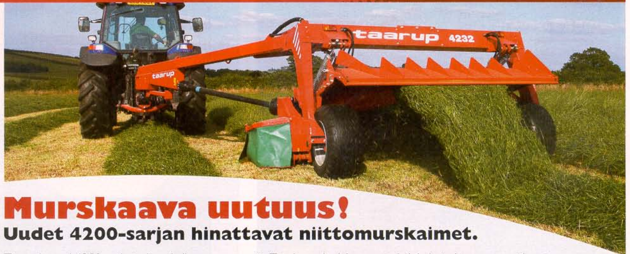
Ohuempi teräpalkki parannelulla suojauksella ja SuperFloat-kevennyksellä.
