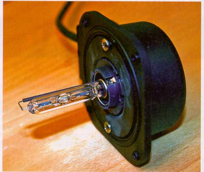
Laatuvalaisimissa myös yksityiskohtiin ja tuotteen käyttöominaisuuksiin on paneuduttu huolella. Eräs tärkeä yksityiskohta on värinänvaimennus.
