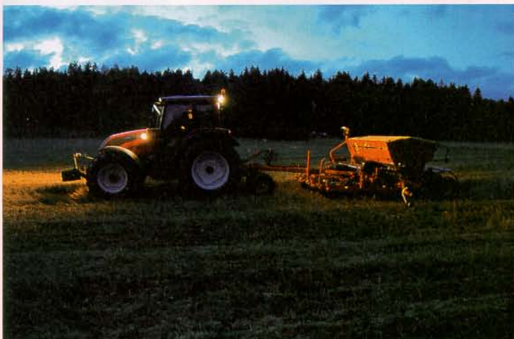
Oikein asennetut ja riittävän tehokkaat työvalot mahdollistavat työpäivän jatkamisen illan pimeässä.
