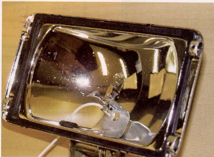
Näillä eväillä ei voi valoteholta suuria odottaa. Heijastinpinta on epätasainen ja polttimon kiinnike peittää siitä suuren osan. Testituloksella yllättänyt: pienin mitattu valoteho. Hinta on kyllä ylivertaisen halpa.
