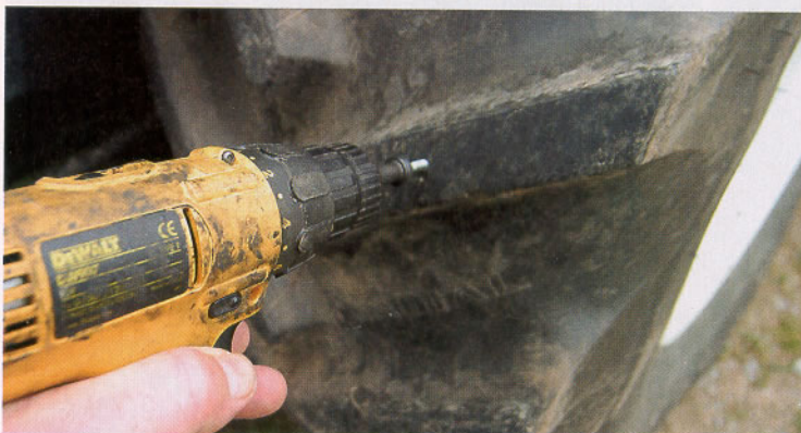
Maxi Grip -nastojen kiinnitys traktorin renkaisiin käy joustavimmin akkuporakoneella. Pyöritysvoiman saa sopivaksi momentinsäädöllä.
