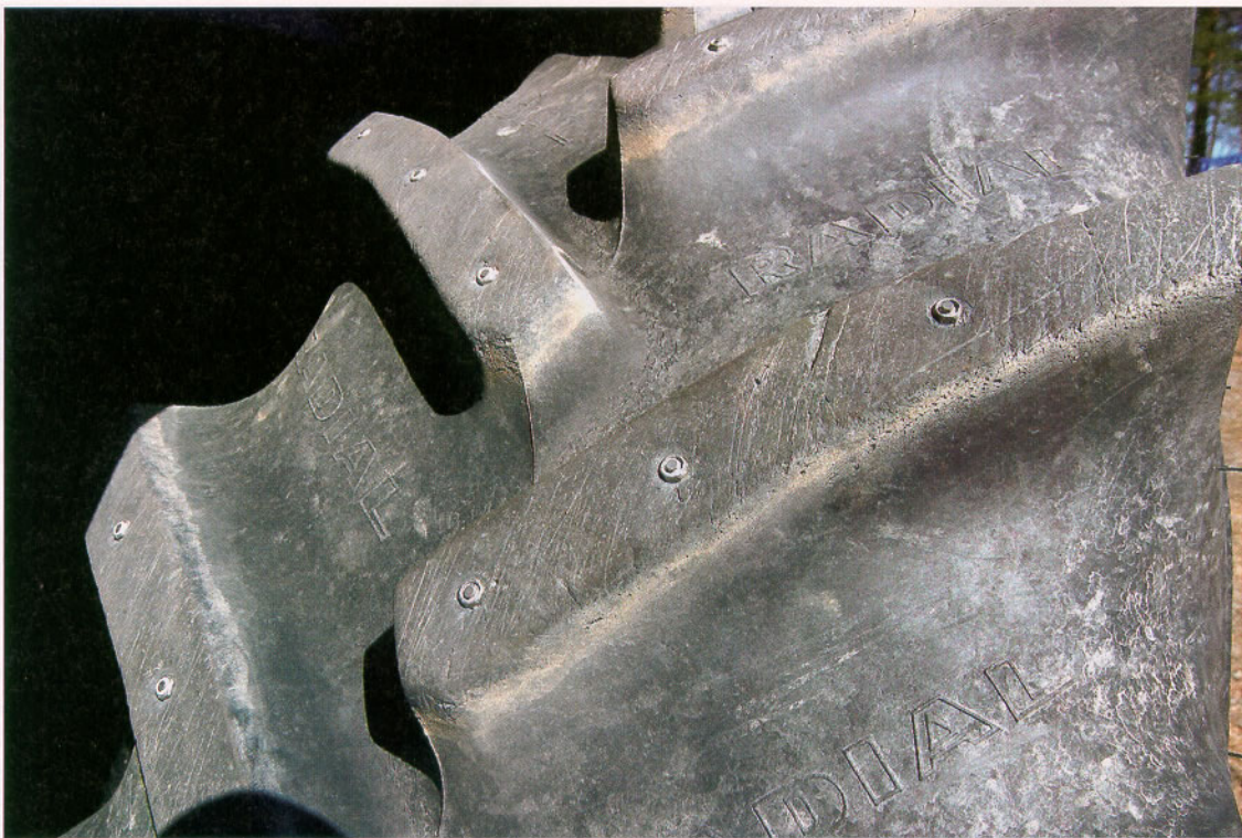
Valmis nastoitus näyttää tältä. Parin 200:n nastan laatikosta riitti kolme nastaa jokaiseen 18,4/34 takarengaankin hakkuun ja eturenkaisiin jäi vielä kaksi nastaa kaikkiin hakkuihin.
