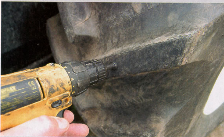
Nastalaatikossa mukana seuraavassa asennusavaimessa on laippa, joka osoittaa sopivan asennussyvyyden.
