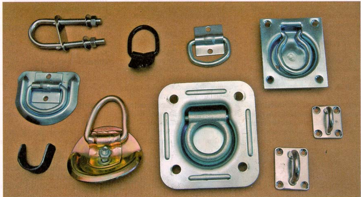
Kuvassa kokoelma testattuja sidontalenkkejä. Koko ei aina kerro suoraan lenkin kestävyyttä, vaikka suurin lenkki osoittautuikin ylivoimaisesti parhaaksi.
