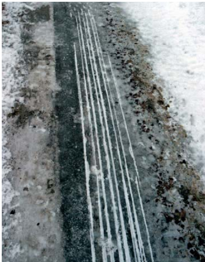
Lukkojarrutus ripakuvioisella renkaalla. Kaksi keskimmäistä naarmua ovat ruuvinautojen ja reunimmaiset tavallisten nastojen vetämiä. Ei havaittavia eroja.
